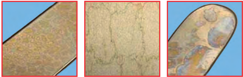
Typische silicaatverkleuringen op het oppervlak van de instrumenten na de stoomsterilisatie door een te hoog gehalte kiezelzuur in het gedemineraliseerd water.
