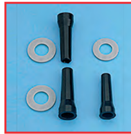
Rechts: opgezwollen pakkingen ten gevolge van het niet-doelgericht aanbrengen van instrumentenolie. Links: nieuwe pakkingen
