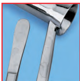
Vlekken op grond van een hoog zoutgehalte in het naspoelwater
