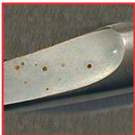
Door chloriden veroorzaakte putcorrosie op een instrument.
