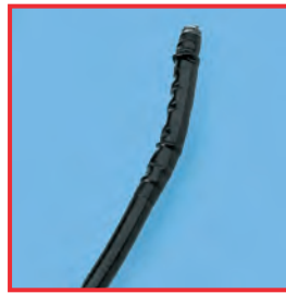
Opzwellen van een invoerslang door gebruik van een ongeschikt onderhoudsmiddel.
