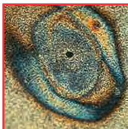
Voorbeeld voor putcorrosie
