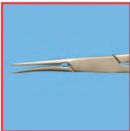
Vervorming door een ondeskundige behandeling
