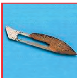
Materiaalaantasting van het klingoppervlak in verband met vocht. Oorzaken: Materiaalsamenstelling, normaal staal aangezien eenmalig product.
