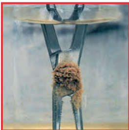
Roestvorming door enige uren onderdompeling in een fysiologische zoutoplossing
