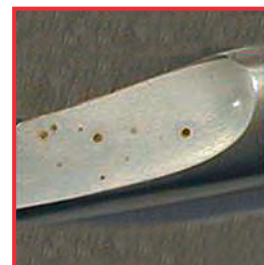
Voorbeeld voor putcorrosie
