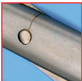
Spanningsscheurtje bij het scharnier van een schaar
