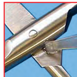
Vermijden: doelgericht onderhoud met instrumentenolie
