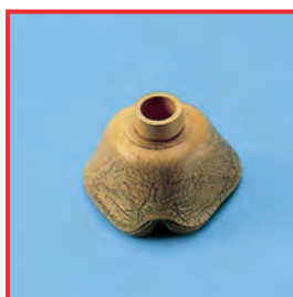
Verouderingsscheuren in een ademmasker
