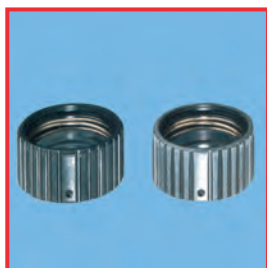
Rechterkant van de afbeelding: Materiaalaantasting van de zwarte anodiseerlaag door onthard water.
