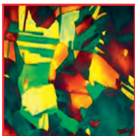
Kleuretsing – austenitische microstructuur roest- en zuurbestendig instrumentenstaal (500-voudige vergroting)
