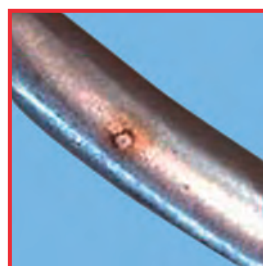
Putcorrosie-aantasting van een pincet. Oorzaken: Veroudering van de kleurcoderingsband maakt infiltratie van schadelijke, chloridehoudende substanties mogelijk.
