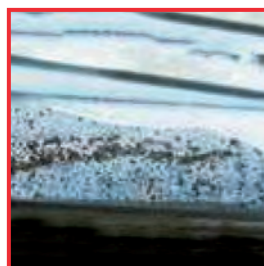
Gedeeltelijke beitsaantasting en afzettingen van een geneesmiddel voor het stelpen van bloedingen op het instrumentenoppervlak. Oorzaken: te lange contacttijd
