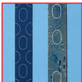
Al bij lichte alkaliteit zijn optische veranderingen bij geanodiseerd aluminium mogelijk
