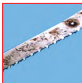
Materiaalaantasting van de deels defecte chroomlaag. Oorzaken: Vocht veroorzaakt roestvorming van de onbeschermde dragermateriaal van normaal staal
