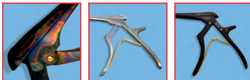
Voorbeeld: zwarte stans met een TiAlN-laag. Bont veelkleurig verkleurd c.q. compleet van laag ontdaan met onbeschadigde vergulde (sluitschroef, veren) componenten.
