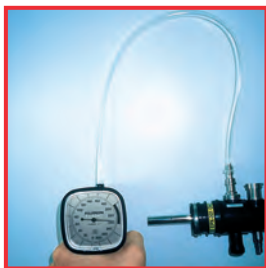
Handmatige controle op lekkage bij een flexibele endoscoop
