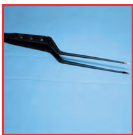
Vervorming door een ondeskundige behandeling
