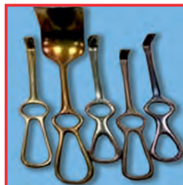
Typische silicaatverkleuringen in de spoelkamer en op het oppervlak van de instrumenten door silicaathoudende reinigingsmiddelen of een te hoog gehalte kiezelzuur in het water.
