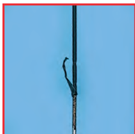
Beschadigde isolatie op een HF-instrument
