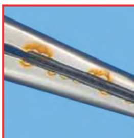
Beitsaantasting van de soldeernaden. Bij hardmetalen scharen, hardmetalen pincetten en naaldhouders Oorzaken: Zuuraantasting door overdosering van de neutralisatiechemie of de toepassing van basisreinigingsmiddelen.
