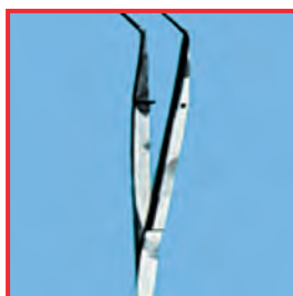
Gedeeltelijke beitsaantasting en afzettingen van een geneesmiddel voor het stelpen van bloedingen op het instrumentenoppervlak. Oorzaken: te lange contacttijd
