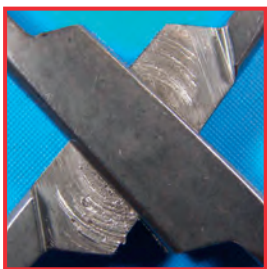
"Metaalinvretingen", ten gevolge van ontoereikend gebruik van onderhoudsmiddelen
